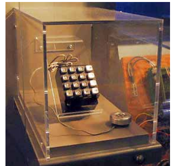
Blue Box, die elektronische Version der Cap'n Crunch-Pfeife.
