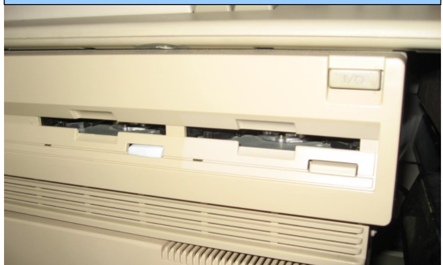
Unten: Ein mit PowerKnete nachmodellierter A3000 Auswurfsknopf für das Diskettenlaufwerk. Noch unlackiert.
